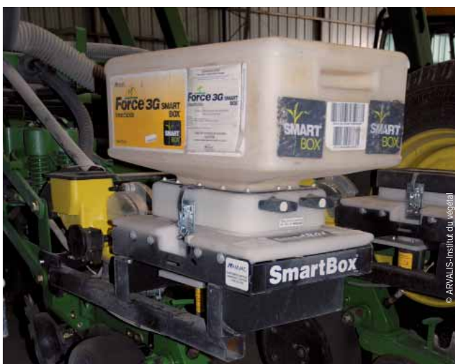
La « Smart Box » évite tout risque d'inhalation ou de contact de l'insecticide avec la peau.
