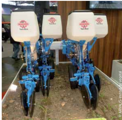
Les semoirs de type « twin-row » permettent d'augmenter le nombre de plantes par mètre carré.
