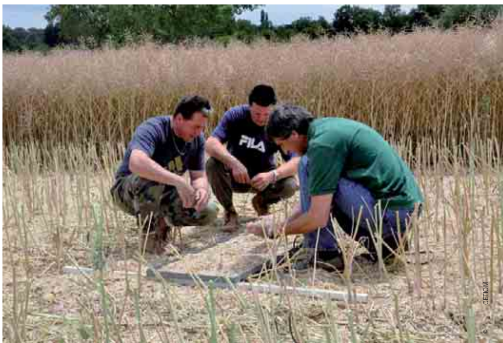
Les pertes arrière, mesurée ici par le CETIOM, augmentent lorsque les pailles transitant par la machine ne sont pas assez sèches.
